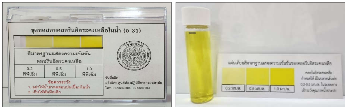
ภาพที่ 1 ชุดทดสอบ อ 31 และการเทียบสีที่เกิดขึ้นกับแผ่นเทียบสีมาตรฐาน
