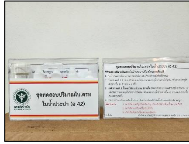
ชุดทดสอบไนเตรทหลังจากการออกแบบที่ได้จากการศึกษาข้อมูลทางวิชาการ
