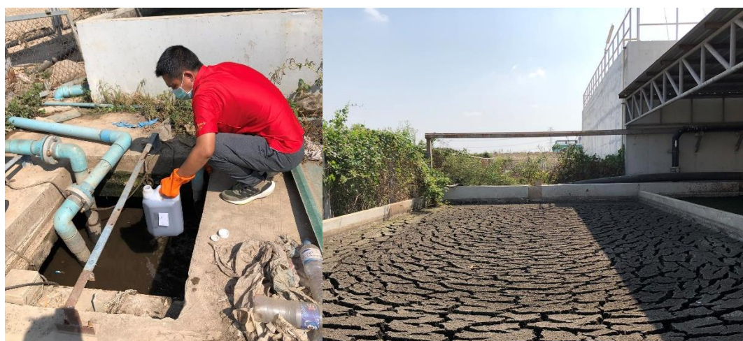
รูปภาพที่ ๑ สุ่มตัวอย่างน้ำทิ้งและกากตะกอนบ่อสุดท้ายที่ผ่านการบำบัดแล้ว
