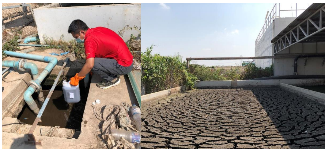
รูปภาพที่ ๑ สุ่มตัวอย่างน้ำทิ้งและกากตะกอนบ่อสุดท้ายที่ผ่านการบำบัดแล้ว
