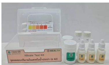
ภาพที่ 11 ชุดทดสอบไนเตรทในน้ําบริโภค หลังจากปรับปรุงแล้วเพื่อให้สะดวกในการใช้งานในพื้นที่จริง
