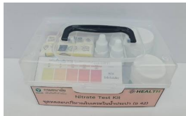
ภาพที่ 11 ชุดทดสอบไนเตรทในน้ําบริโภค หลังจากปรับปรุงแล้วเพื่อให้สะดวกในการใช้งานในพื้นที่จริง
