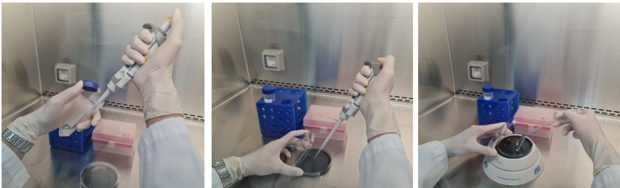
ภาพที่ 2 ขั้นตอนการแยกเชื้อให้บริสุทธิ์ โดยใช้เทคนิค Spread plate
