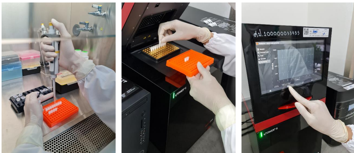
ภาพที่ 5 ขั้นตอนการเตรียม master mix และการตั้งค่าสภาวะของปฏิกิริยา สำหรับการเพิ่มปริมาณสารพันธุกรรมของเชื้อ Legionella spp.
