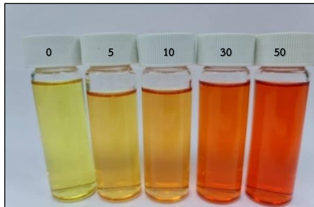
ภาพที่ 3 การเกิดสีของสารมาตรฐานไนเตรท ที่ระดับความเข้มข้น 0 5 10 30 และ 50 มิลลิกรัมต่อลิตร
