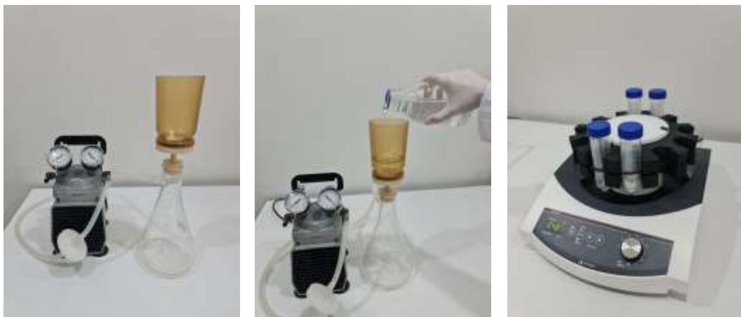
ภาพที่ 8 ขั้นตอนการทำให้ตัวอย่างเข้มข้นขึ้น ด้วยวิธีการกรอง (Membrane filtration)
