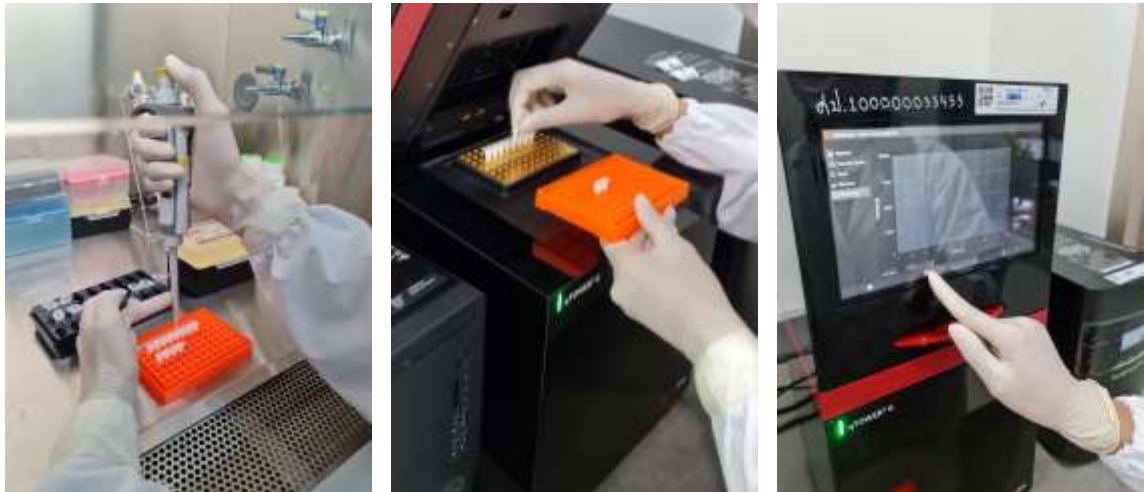
ภาพที่ 12 ขั้นตอนการเตรียม master mix และการตั้งค่าสภาวะของปฏิกิริยาสำหรับการเพิ่มปริมาณสารพันธุกรรมของเชื้อ Legionella spp.
